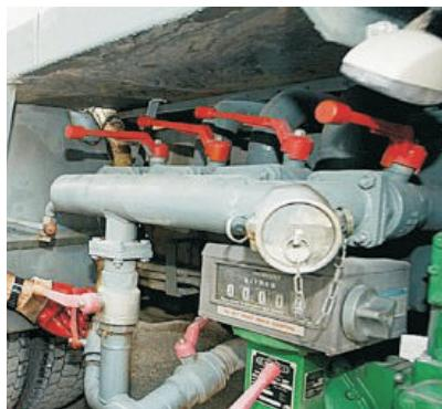
Αν έχετε μεταλλική δεξαμενή, συμβουλευτείτε το μετρητή του βυτιοφόρου ως βοηθητικό τρόπο μέτρησης.
